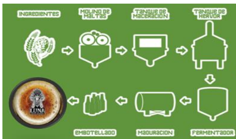
Figura 4 Proceso de Producción de la Cerveza Artesanal
