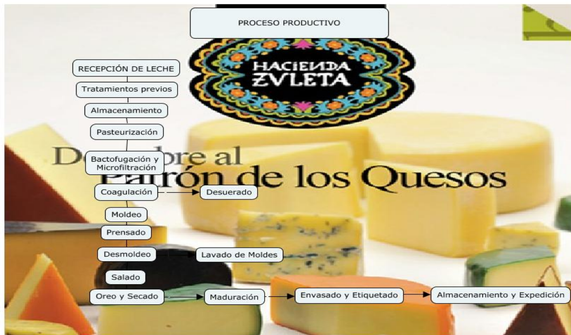
Figura 9. Diagrama del proceso productivo Zulac S.A.
